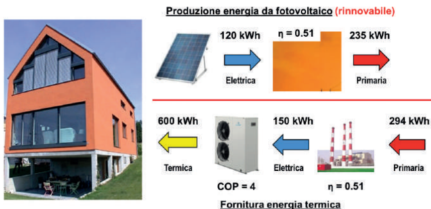
Figura 9 – Esempio di calcolo del fabbisogno mensile di energia primaria da fonti non rinnovabili
