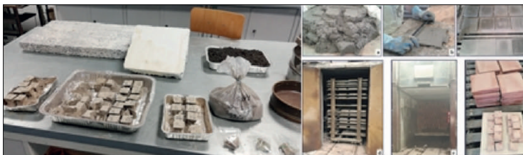
Figura 1. Prodotti confezionati a partire da ceneri o lapilli dell'Etna (a sinistra malte, intonaci e pannelli isolanti; a destra piastrelle ceramiche)
